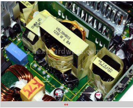
Particolare del trasformatore.
