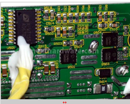
Particolare del circuito DC-DC per la generazione delle tensioni da 5 e 3,3 Volt.
