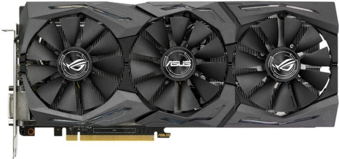
Tutte le schede della serie STRIX sono prodotte utilizzando tecnologie proprietarie ASUS come l'efficiente sistema di raffreddamento DirectCU III che si avvale delle esclusive ventole Wing Blade in grado di assicurare una pressione statica del 105% maggiore rispetto alle soluzioni standard, che entrano in funzione solo oltre una certa soglia di carico e di temperatura grazie alla funzionalità integrata "0dB".
