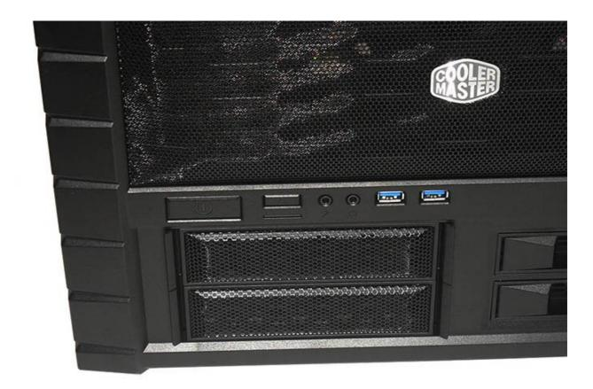
Il pannello di I/O, come abbiamo accennato nella pagina precedente, è piuttosto essenziale e comprende il pulsante di accensione di forma rettangolare, quello di reset sotto al quale è presente il LED di stato, gli ingressi per audio e microfono le connessioni USB 3.0 con plug a 20 pin da collegare sull'header presente sulle schede madri di recente generazione.
