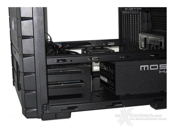
Anche installando un alimentatore di lunghezza standard però, lo spazio di manovra in corrispondenza delle connessioni risulterà appena sufficiente.
