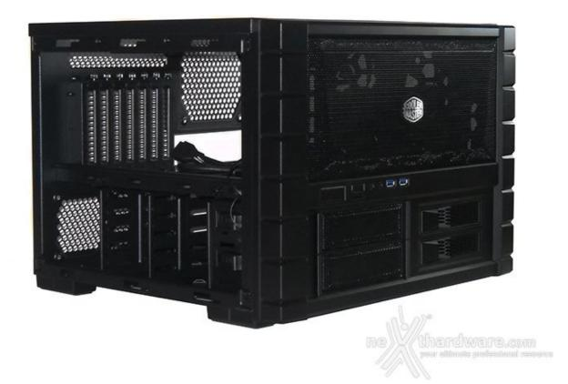
Come si può notare dalla foto in alto, i pannelli laterali e quello superiore sono completamente removibili, trasformando il LAN Box in un Bench Table a tutti gli effetti.
