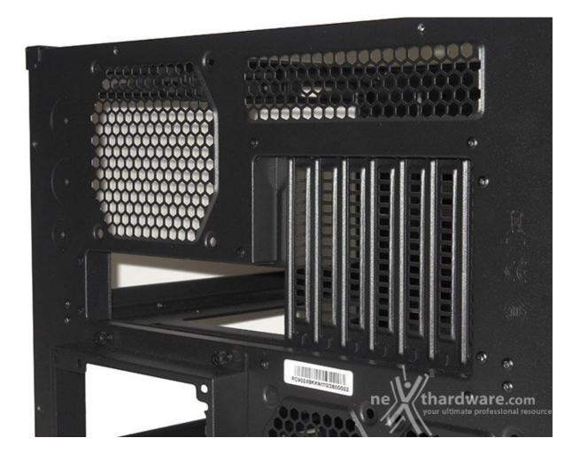
Sulla parte posteriore è possibile notare la predisposizione per una ventola da 120 mm (non inclusa nel bundle) e gli slot di espansione.
