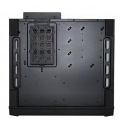
La parte superiore comprende una parte in rilievo su cui è disposta una generosa griglia, al di sotto della quale è possibile installare una ventola da 200mm.
