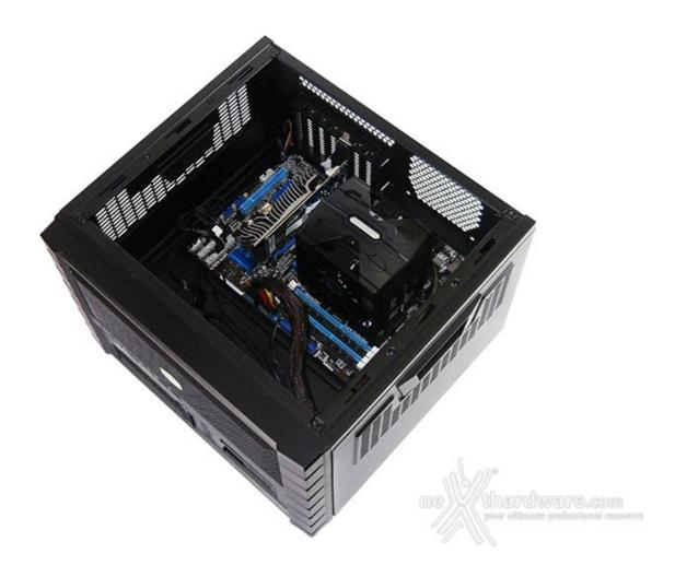
Ecco come si presenterà internamente il case, una volta effettuato il cablaggio ed inserito il vassoio con la scheda madre installata.
