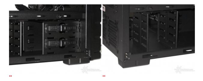
Sulla parte laterale sono presenti gli alloggi per i drive da 5.25" con un sistema di ritenzione tool-less costituito da linguette in plastica, identico a quello utilizzato da Cooler Master per tutti gli altri case della serie HAF.
