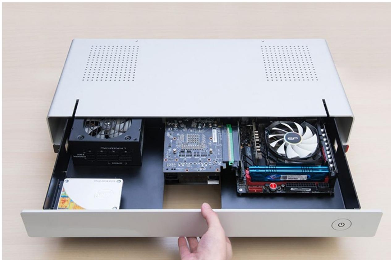
Usufruendo di una scheda video lunga 250mm, un drive da 3,5" o due da 2,5", al suo interno potrà essere assemblato anche un sistema pensato per la realtà virtuale.
