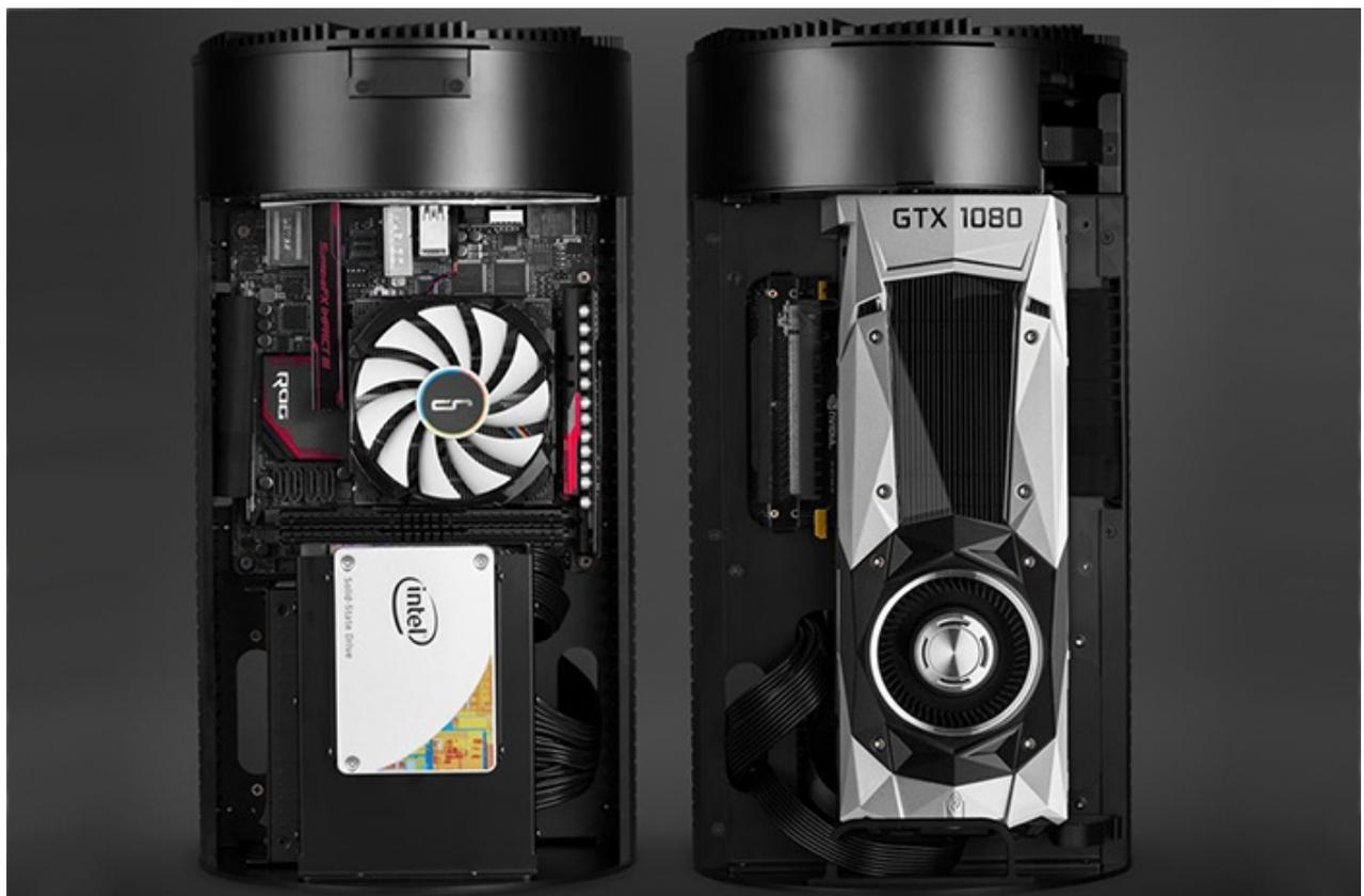
L'OLA è uno chassis cilindrico, in stile Mac Pro, capace di contenere hardware di tutto rispetto, tra cui una mainboard ITX di fascia alta con dissipatori a basso profilo, SSD, HDD ed una scheda video di ultima generazione come le nuove arrivate NVIDIA GeForce GTX 1080.
