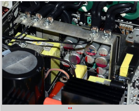
Data l'estrema vicinanza della daughter-card dello stadio secondario sia al trasformatore che al PCB delle connessioni modulari ed alla presenza dell'elemento metallico di raccolta che copre i componenti, non siamo in grado di fornire indicazioni sul numero e modello di rettificatori utilizzati.
