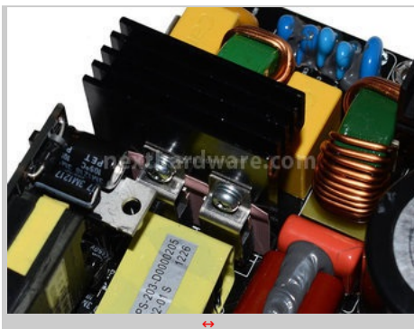
Particolare dello stadio primario di switching.
