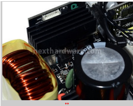
Particolare del diodo e dei Mosfet riservati al sistema di controllo del fattore di potenza:
