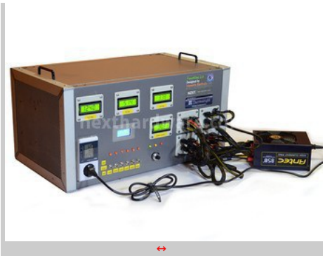
PowerKiller 2.0 Banco progettato per testare alimentatori fino a 2185W.
