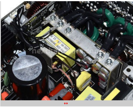
Particolare del trasformatore.
