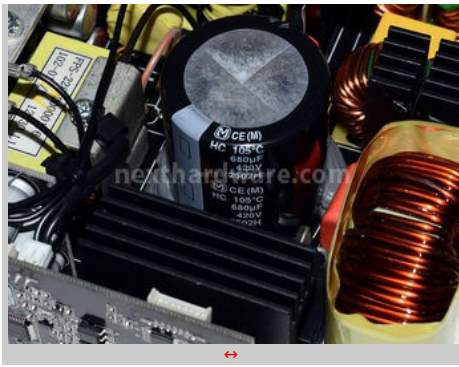
Condensatore primario Panasonic
