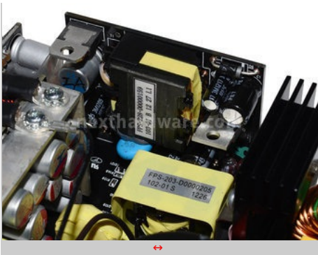
Particolare della daughter-card relativa alla tensione da 5V di stand-by.
