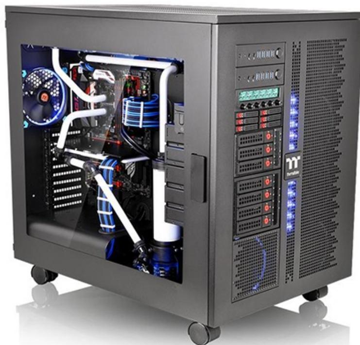
Il W200 è un Super Tower con dimensioni pari 677x475x678mm dal peso di 28,9kg, che è in grado di ospitare ben due schede madri in formato XL-ATX o inferiore, 3 drive da 5,25" e addirittura 14 tra HDD e SSD da 3,5" o 2,5".
