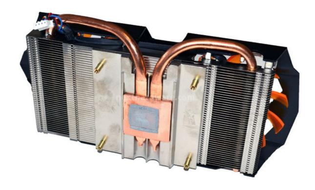
Il design della scheda ricorda quello della sorella maggiore Zotac GeForce GTX 660 Ti anche se un occhio esperto può distinguerle per il differente numero di heatpipes installate nel sistema di raffreddamento: tre nella GTX 660 Ti e due nella GTX 660.
