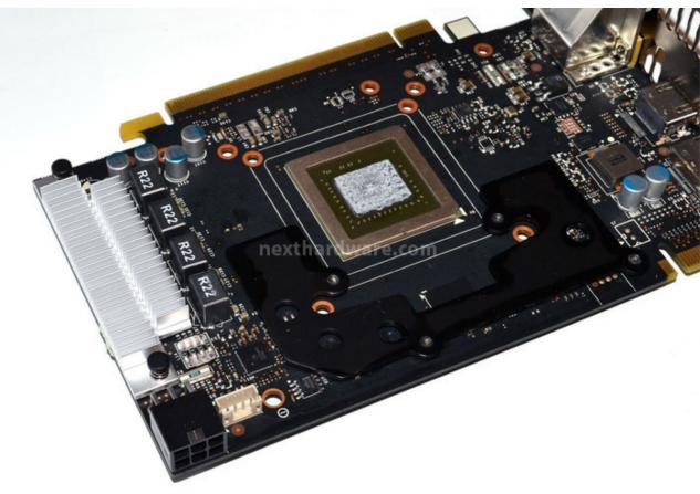
A differenza delle altre schede provate fino ad oggi, la placca posta sulle memorie non sembra avere un ruolo attivo nel raffreddamento delle stesse: il terzo modulo di memoria, infatti, è coperto solo per metà ed i moduli posteriori non sono sormontati da alcun dissipatore.
