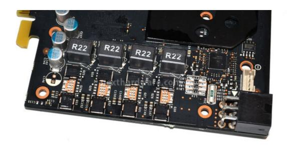
Il circuito di alimentazione della Zotac GeForce GTX 660 è raffreddato da un piccolo dissipatore in alluminio, sotto il quale sono posti i Mosfet relativi alle quattro fasi dedicate alla GPU.
