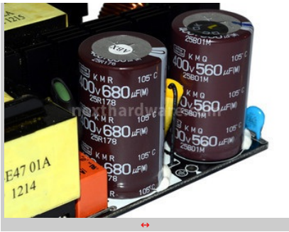
Condensatori d'ingresso Nippon Chemi-Con.
