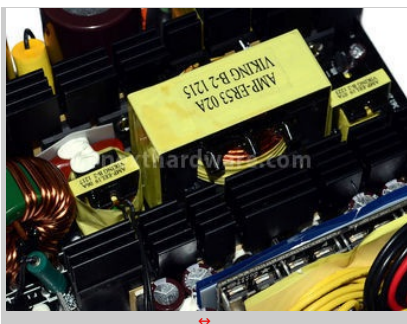
Particolare del trasformatore principale.
