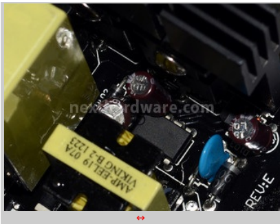
Controller PWM di stand-by.
