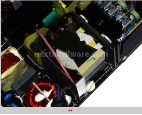
Particolare del trasformatore principale.
