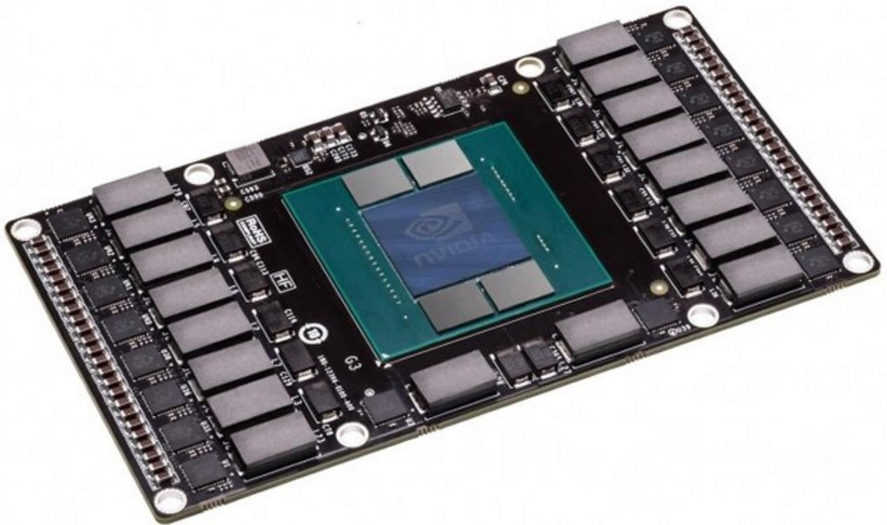
Riassumendo, sempre secondo le indiscrezioni trovate in rete, per la GPU Pascal in versione top di gamma ci dovremo aspettare un'architettura Maxwell evoluta con un aumento significativo di unità di calcolo (4500/6000 shader), non meno di 17 miliardi di transistor, processo produttivo FinFET a 16nm di TSMC ed un quantitativo di memoria HBM2 di 16GB, ma non è escluso anche di vedere esemplari equipaggiati con 32GB (che è il valore massimo supportato).
