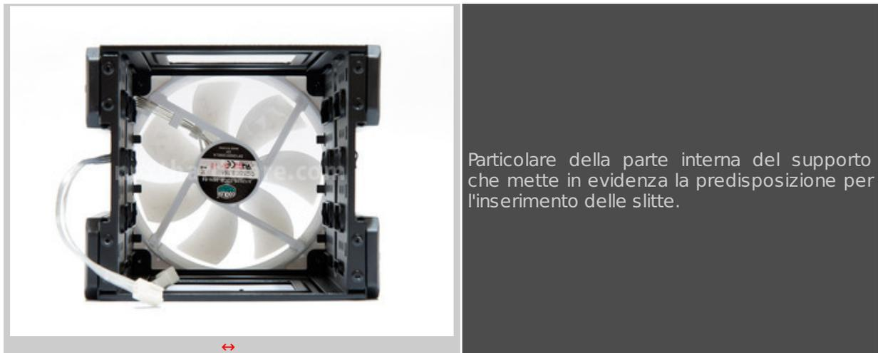
Particolare della parte interna del supporto che mette in evidenza la predisposizione per l'inserimento delle slitte.
