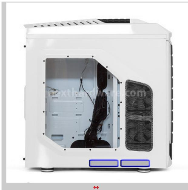
Le ventole opzionali sono in numero di due↔ e posizionabili sul pavimento del case, previa la rimozione del cassetto anteriore e del cestello per HDD/SSD da 2,5".
