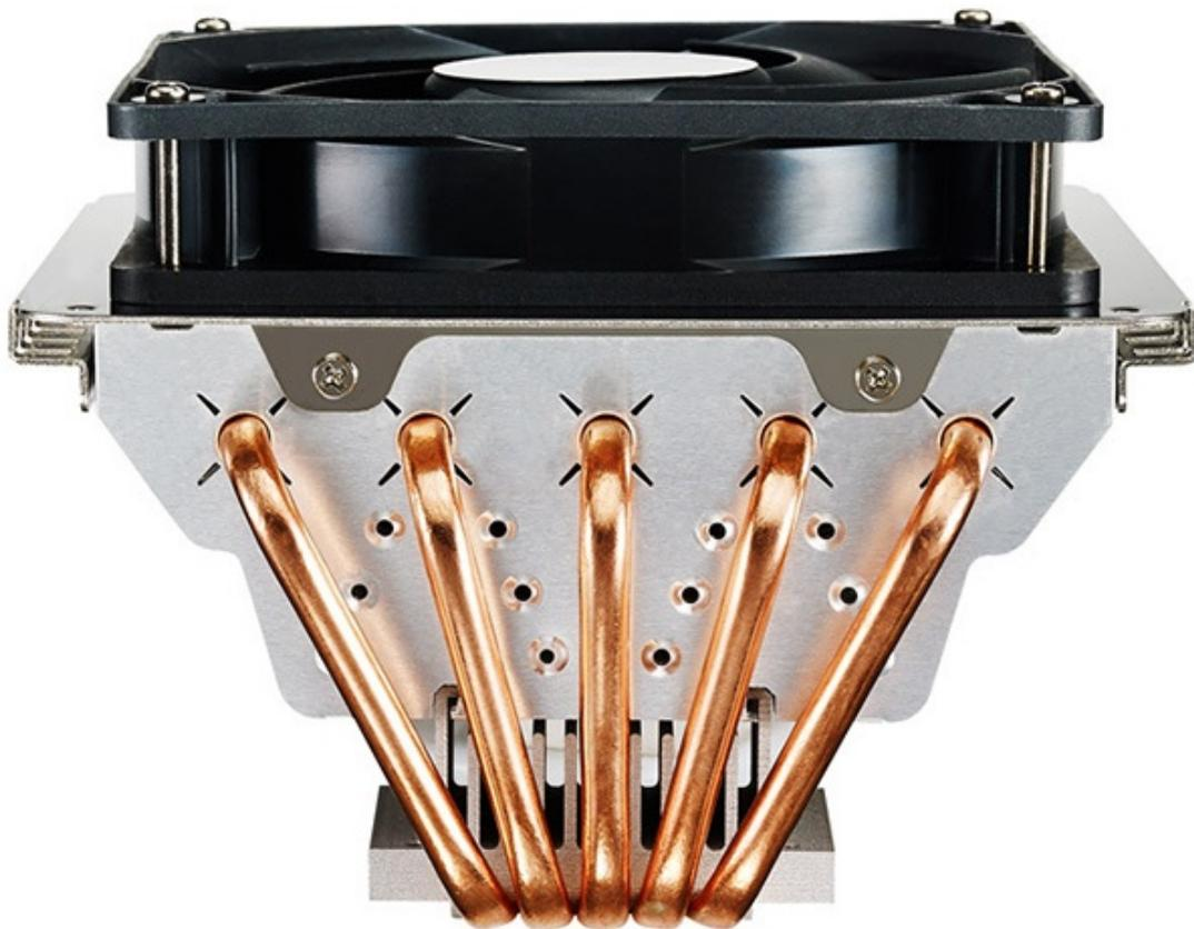
Tutte e cinque le heatpipes convergono in un corpo lamellare molto ampio, studiato appositamente per agevolare al massimo il flusso proveniente dalla ventola Silencio FP PWM posta sopra di esso, che sarà quindi in grado di spostare un gran quantitativo d'aria producendo poco rumore.
