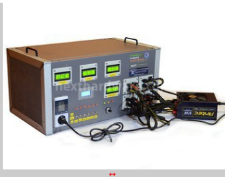
PowerKiller 2.0 Banco progettato per testare alimentatori fino 2185W.
