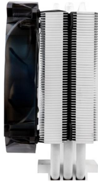
Il Dark Knight II SD1483 misura 120 (W) x 50 (D) x 159 (H) mm ed è dotato di una base in rame attraversata da tre heatpipes da 8mm poste a contatto diretto con l'IHS della CPU.
