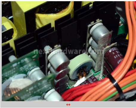
↔ Particolare dei condensatori di filtraggio.
