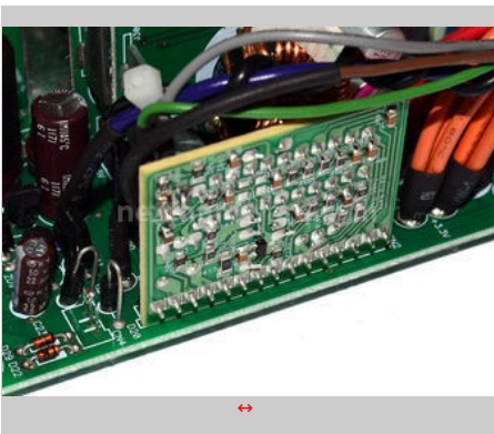
Particolare della scheda del circuito di monitoraggio e di gestione della ventola.
