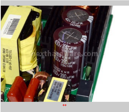
Condensatori in ingresso.
