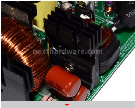
Particolare del ponte raddrizzatore.
