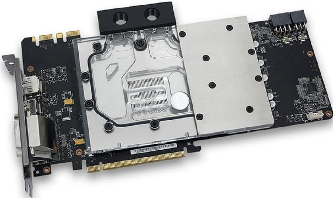
EK Water Blocks ha presentato un nuovo waterblock Full Cover per↔ la ASUS GTX 980 Strix, una versione di VGA non reference basata su GPU Maxwell GM204.
