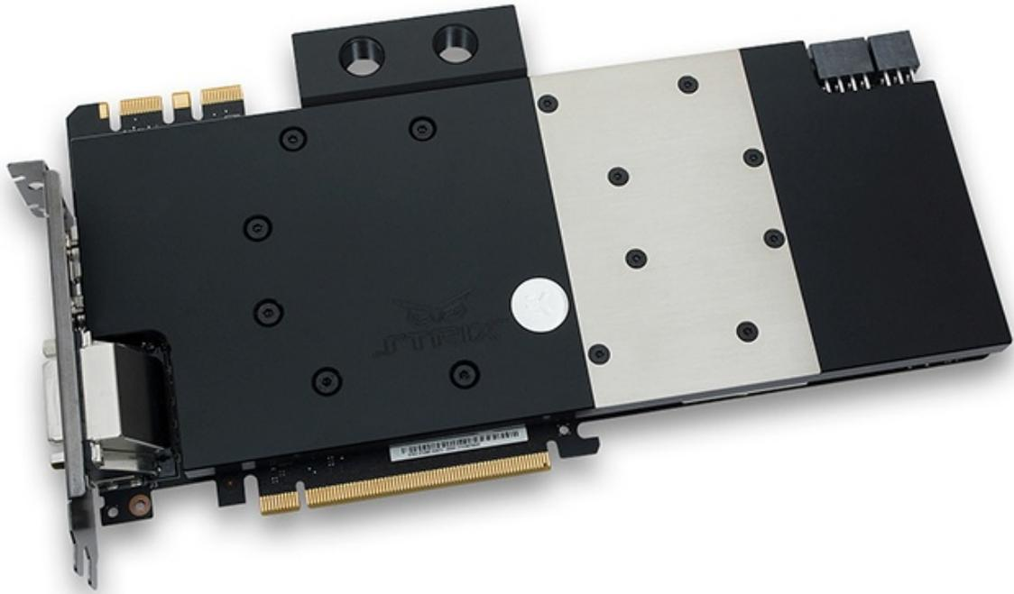
Il waterblock dispone di un diffusore centrale particolarmente ottimizzato per accelerare il flusso sulla GPU, funzionando indifferentemente dal verso di ingresso e offrendo una moderata resistenza, in modo da essere utilizzato anche in abbinamento a pompe non particolarmente potenti.
