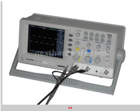
Osciloscopio: ↔ Gw-Instek GDS-1022 ↔ 2 * 25MHz
