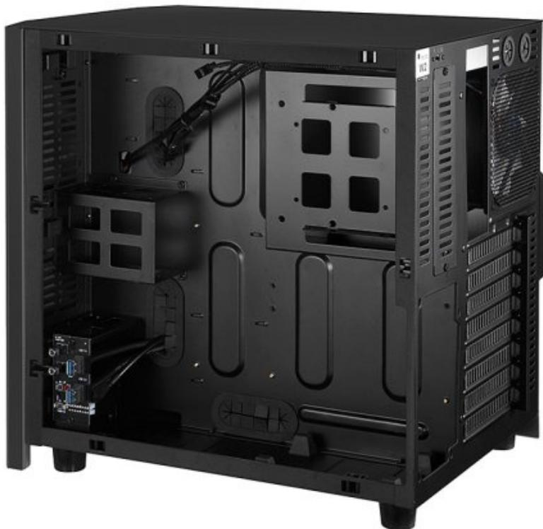
Il vantaggio derivante da questo specifico design sta nel mantenere separati i componenti tradizionalmente più caldi come CPU e VGA dagli altri, allungandone l'aspettativa di vita grazie ad una migliore gestione del sistema di raffreddamento.↔
