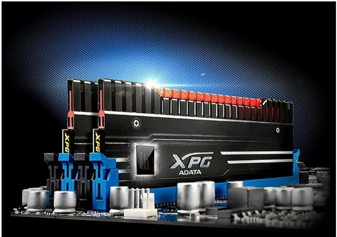
Con una velocità di targa fino a 3100MHz ed una larghezza di banda pari a 24,8 GB/s, la serie XPG V3 alza ancora una volta l'asticella delle prestazioni in overclock.
