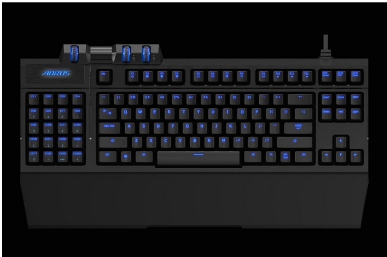
I controlli del volume e dell'illuminazione sono affidati a delle rotelle di scorrimento del tutto identiche a quelle usate nei mouse, inserite sul margine superiore dello chassis, che ricordano molto da vicino quelle viste sulla GIGABYTE Aivia Osmium.
