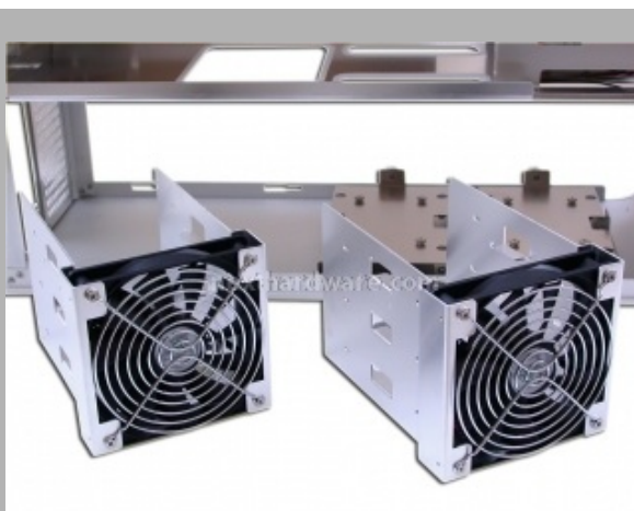
I cassettei estratti e pronti per il montaggio degli hard disk.
