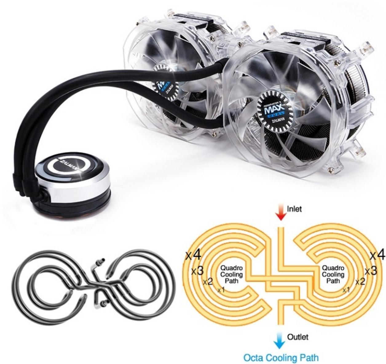
All'interno di questo speciale radiatore costruito interamente in rame e placcato in Nichel per una migliore resistenza all'ossidazione, il liquido di raffreddamento segue un percorso analogo a quello di ben quattro radiatori compatti nello spazio occupato da due, dalla zona più interna e più calda, dove arriva provenendo dal waterblock, per fluire poi verso quella più esterna e fredda.
