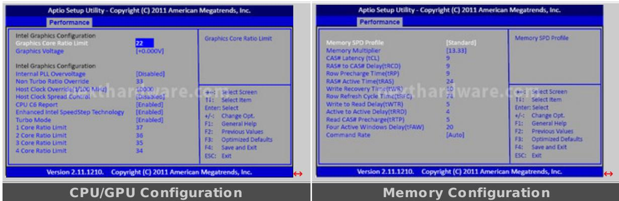
Il menù CPU/GPU Configuration ci permette di variare il moltiplicatore della CPU, il BCLK e di attivare/disattivare il Turbo.
