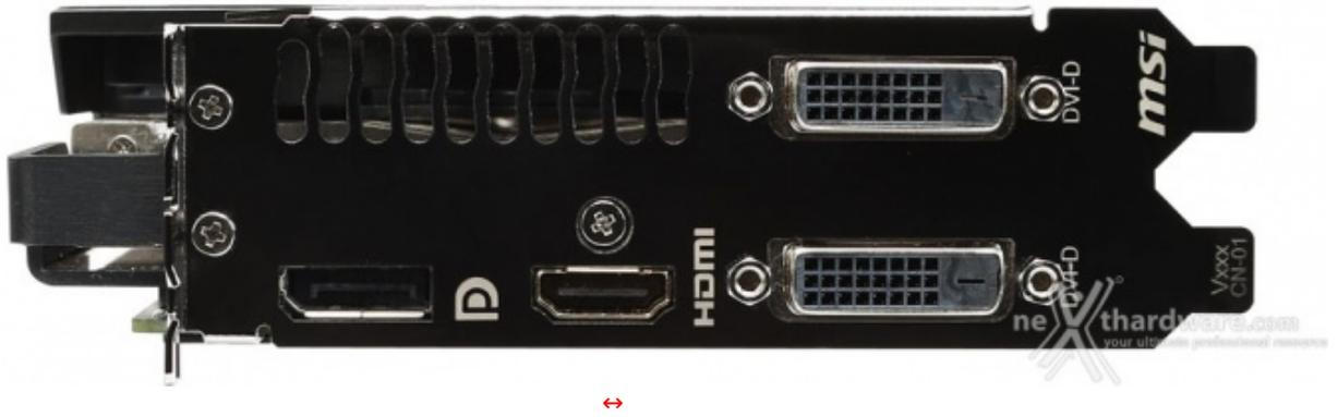
Le uscite video a disposizione sono quattro, ovvero una DisplayPort, una HDMI e due DVI-D DL.
