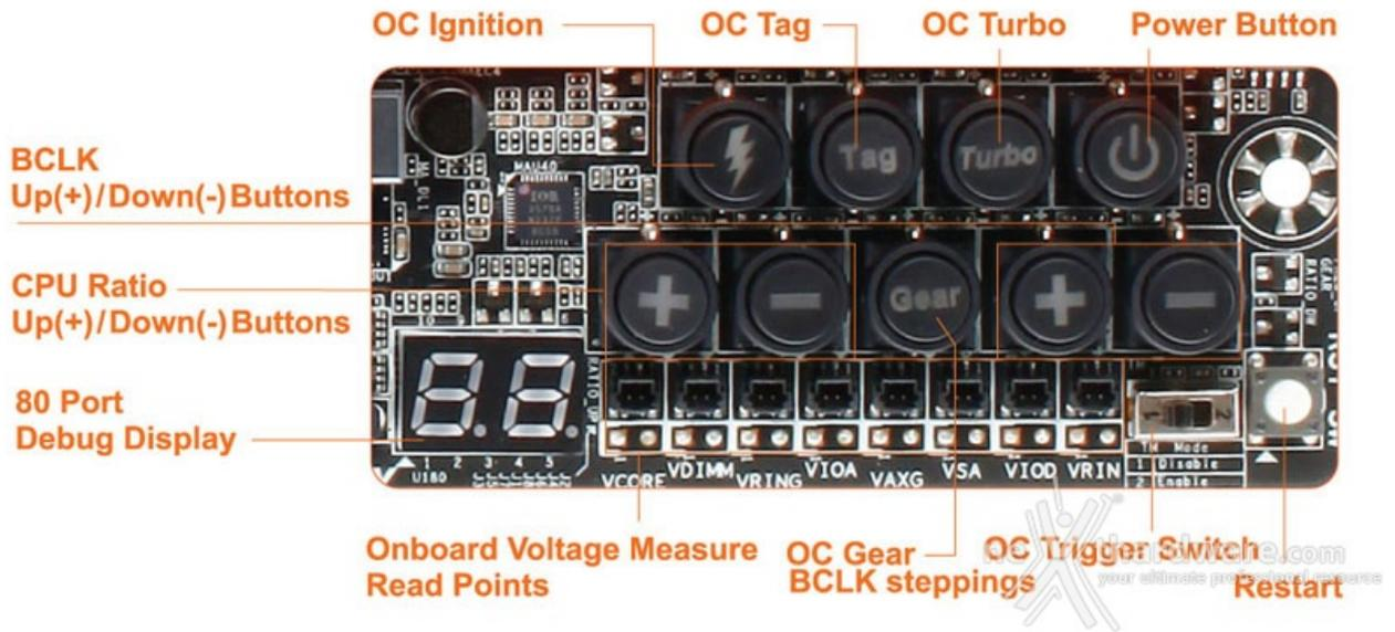
L'overclock, inoltre, può essere effettuato anche senza entrare nel Bios UEFI, utilizzando i pulsanti OC Touch presenti sul PCB.
