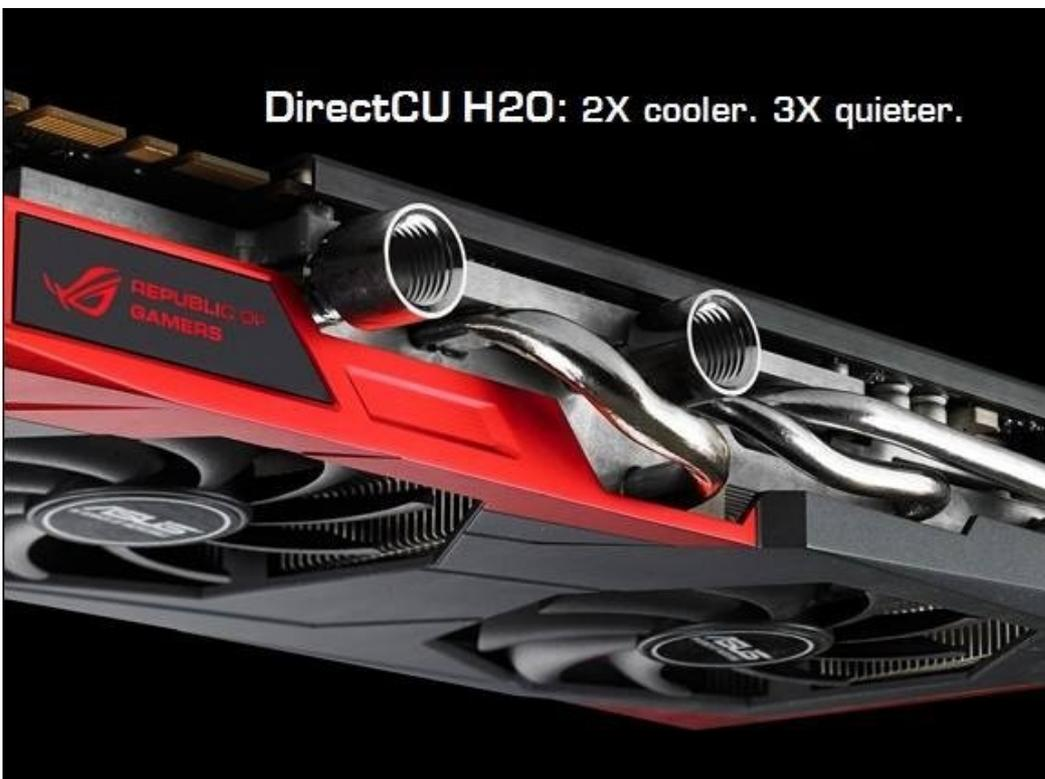
Il dispositivo di raffreddamento utilizzato prevede l'utilizzo di un voluminoso corpo dissipante (presumiamo in rame) sormontato da due ventole, a cui sono collegate tre heatpipes, ed un waterblock che dovrebbe interessare anche i componenti più critici della scheda.
