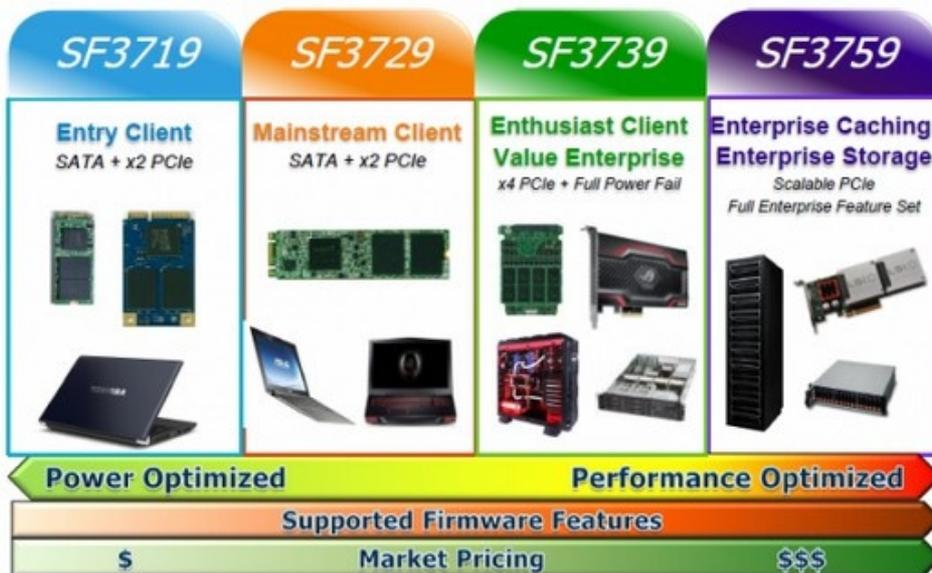
La famiglia di controller LSI SandForce SF3700 comprenderà il modello **SF3719** con interfaccia SATA + PCIe x2 destinato al mercato Entry Client, il modello **SF3729** con interfaccia SATA + PCIe x2 destinato al mercato dei Mainstream Client, il modello **SF3739** con interfaccia PCIe x4 destinato agli Enthusiast Client e Value Enterprise e, infine, il modello di punta **SF3759** destinato ad unità di caching e di storage di classe Enterprise.
