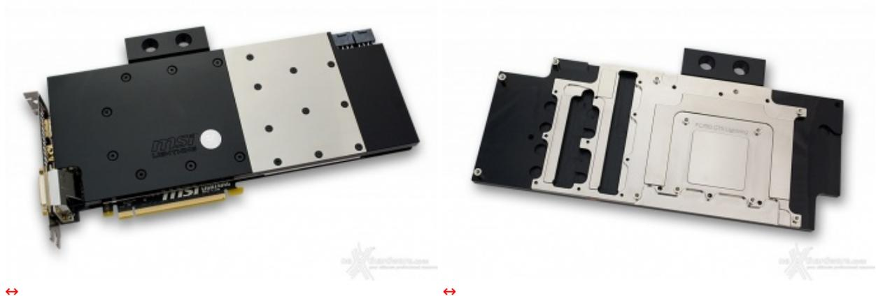
Come le soluzioni rilasciate per le altre schede video top di gamma dei vari brand, anche il modello EK-FC780 GTX Lightning va a raffreddare direttamente tutte le aree critiche, ovvero GPU, RAM e VRM (Modulo di regolazione della tensione), consentendo un overclock stabile anche spingendo le frequenze fortemente fuori specifica.↔
