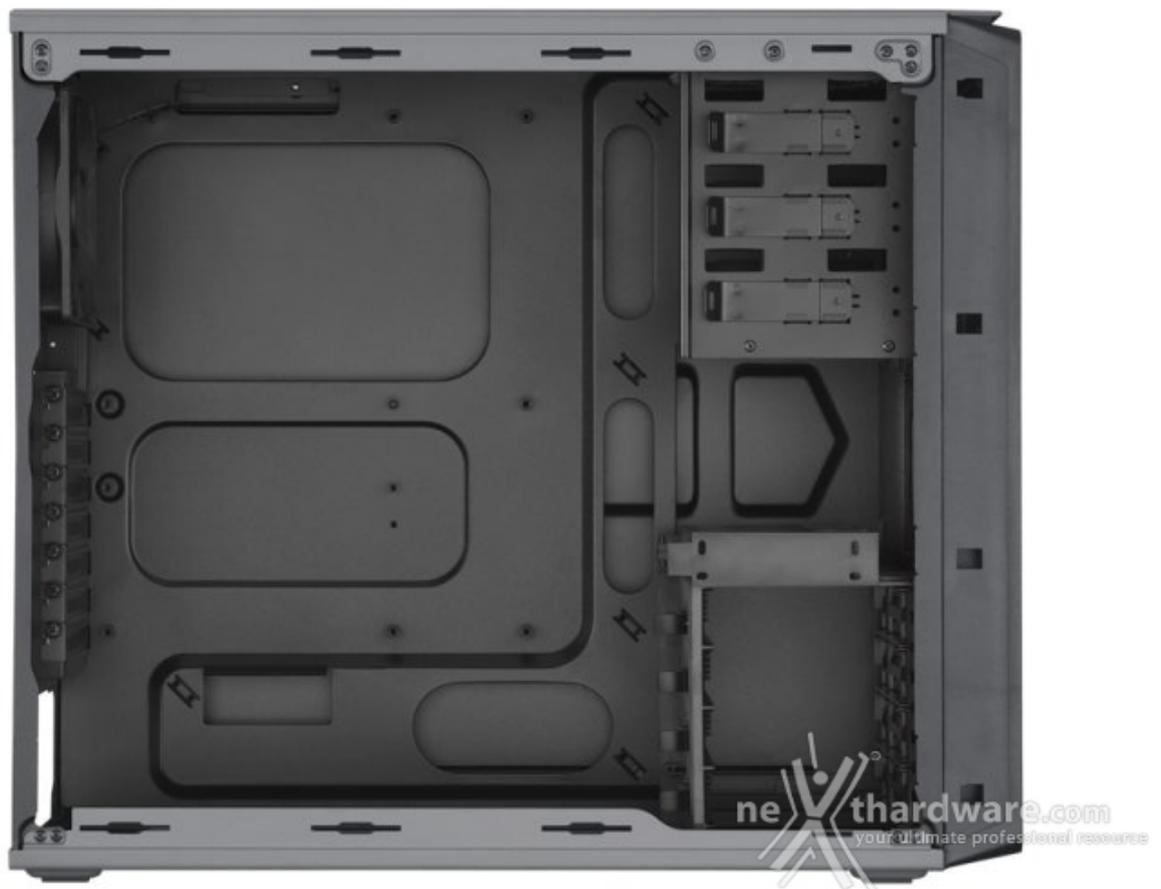
L'interno, rigorosamente verniciato di nero, è abbastanza ampio da poter ospitare schede madri in formato Mini ITX, mATX e ATX, configurazioni multi GPU, grazie ai sette slot di espansione, ed un comparto storage che prevede sette bay, di cui tre da 5.25" e quattro da 2.5/3.5".
