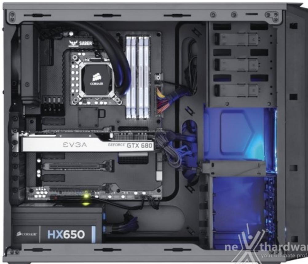
Al fine di rendere più semplice possibile l'assemblaggio del proprio sistema, sono state realizzate tre ampie fessure passacavo sul vassoio della scheda madre, un ampio scasso nella zona del socket della CPU per l'installazione di un dissipatore aftermarket senza la preventiva rimozione della scheda madre e sistemi tool-less per i pannelli e le unità di storage.
