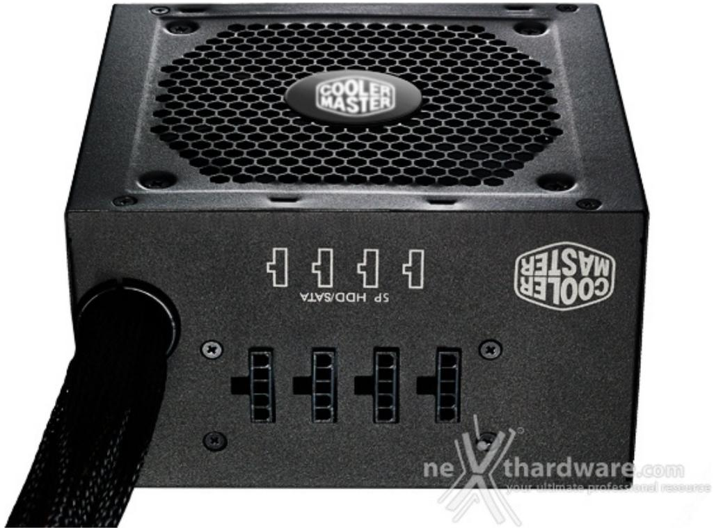
Gli alimentatori GM Series sono caratterizzati inoltre dalla presenza di un unico Rail sulla +12V, per un corretto bilanciamento dei carichi pesanti ed una migliore compatibilità con le schede grafiche di ultima generazione.↔
