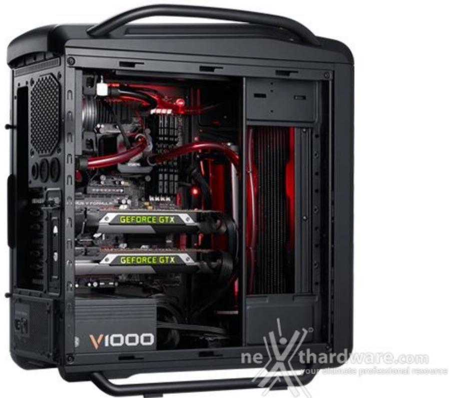
Un'ulteriore predisposizione per radiatori da 120mm è disponibile nella parte posteriore, perfetta per l'installazione di un kit a liquido integrato della serie Seidon o Eisberg.
