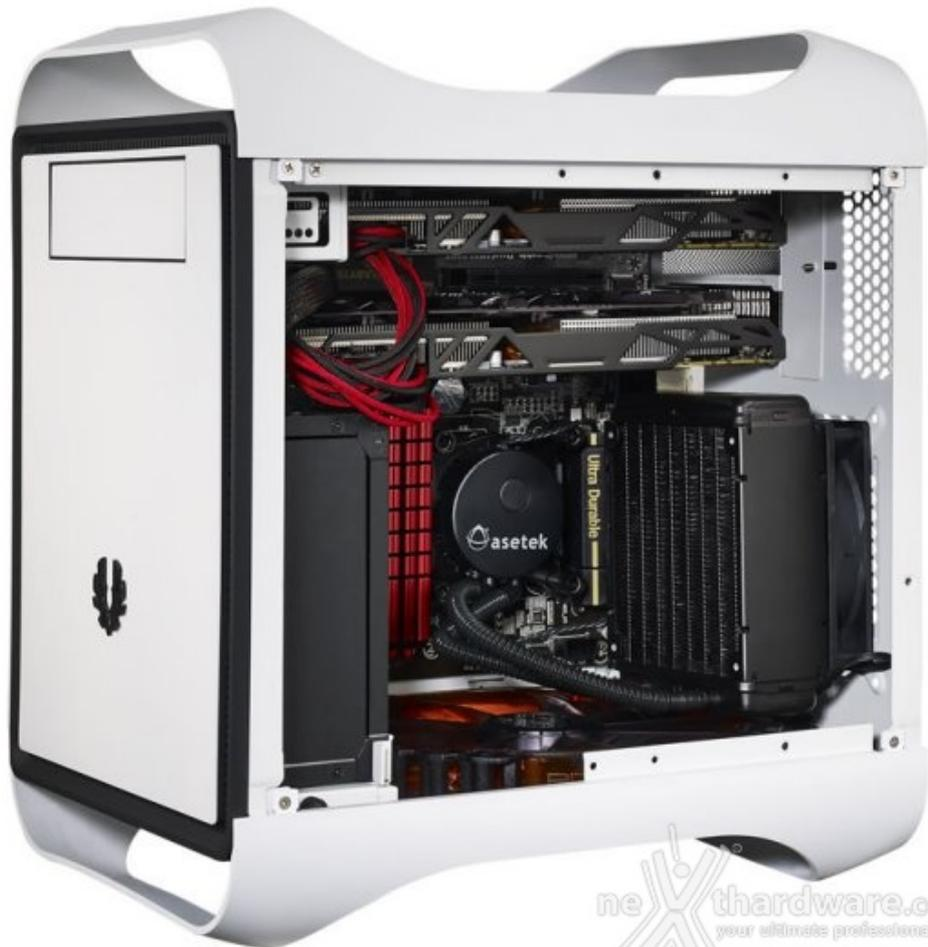
Gli slot di espansione passano da due a cinque, consentendo l'installazione di schede video più ingombranti, l'alimentatore ATX viene ora montato nella parte anteriore ed il pescaggio dell'aria fresca dall'esterno avviene tramite una o più ventole posizionate sul fondo.
