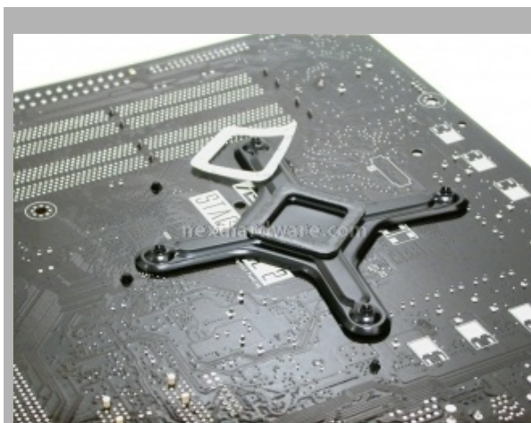
Il Backplate per socket 775 pronto al fissaggio per mezzo dell'adesivo di cui e' dotato
