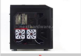
Giungiamo quindi al termine del nostro lavoro; dal momento che il pannello laterale è in grado di ospitare ulteriori dispositivi di ventilazione, optiamo per aggiungerne due a raffreddare la VGA.
