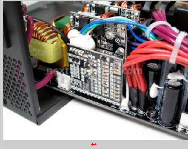
Mini-Board per la gestione dei sistemi di protezione e della temoregolazione della ventola.
