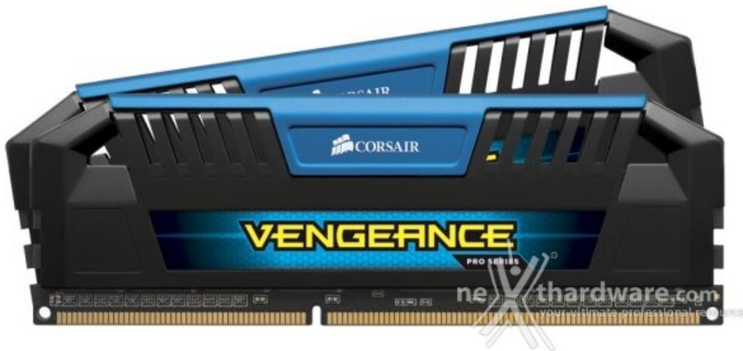
I moduli di memoria Vengeance Pro sono realizzati con un PCB ad otto strati e chip appositamente selezionati per garantire velocità e affidabilità senza precedenti.
