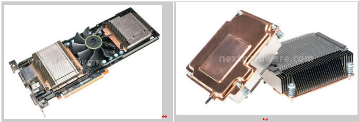
Ogni GPU è raffreddata da una Vapor Chamber in rame abbinata ad un radiatore in alluminio, che permette di non trasferire il calore di una GPU a quella adiacente e che non interferisce con la dissipazione degli altri componenti installati sul PCB.
