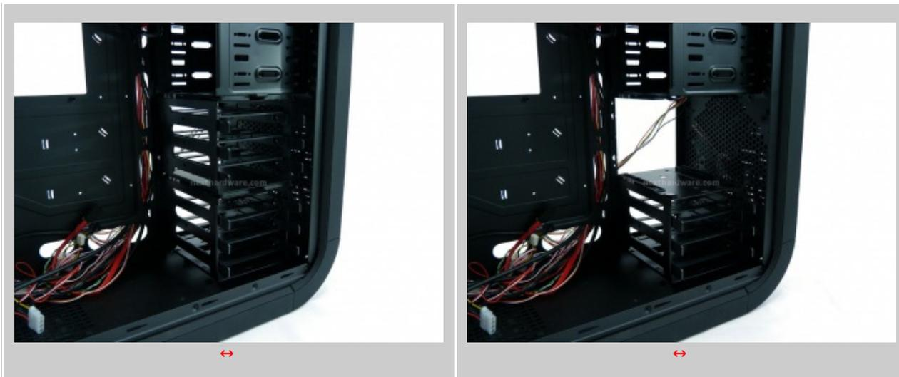
Il sistema di bloccaggio del cestello è delegato solo ai binari di plastica rigida che vedete nella seconda foto, rendendo il fissaggio poco sicuro. Avremmo preferito almeno un paio di viti per un fissaggio definitivo, visto che durante le nostre prove, il cestello tende a sfilarsi anche con un solo hard disk installato.
