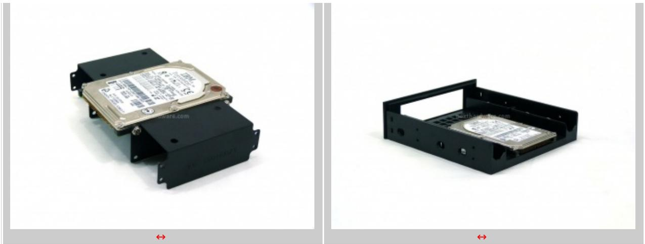
Di contro, il sistema di ritenzione dei dischi rigidi è eccezionale sotto tutti i punti di vista. I dischi si installano semplicemente con una rotazione, la plastica è molto flessibile al centro, i pin metallici di fissaggio sono sormontati da un'asola di gomma morbida: splendidi!
