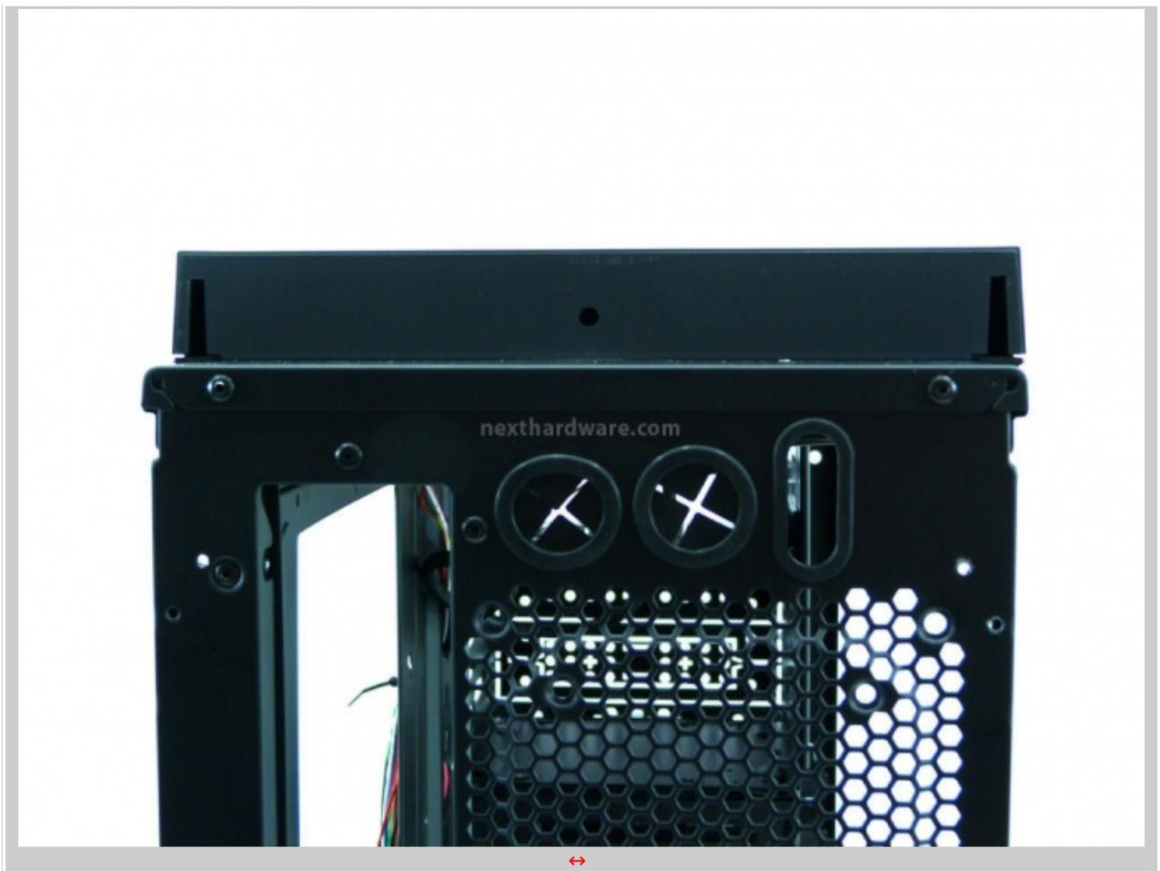
Da notare anche i due fori, protetti da guarnizioni in gomma morbida, per il passaggio di eventuali tubi per il raffreddamento a liquido, accompagnati da un'asola di generose dimensioni per il passaggio dei cavi delle ventole di un eventuale radiatore esterno.
