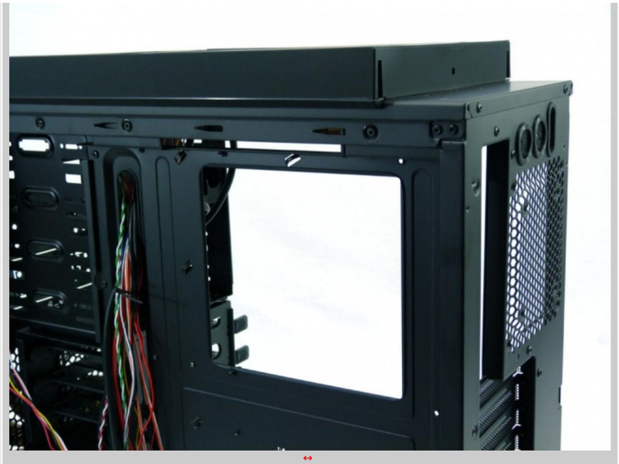
Esaminando la parte alta del piatto della motherboard, riscontriamo con piacere come il vano sia di dimensioni maggiorate, rispetto allo standard, in modo da garantire una comoda sostituzione del dissipatore. I bordi del vano non sono protetti da alcuna guarnizione, il metallo è semplicemente ribattuto all'interno creando così un contorno arrotondato. Diamo anche uno sguardo alla ventola da 200mm a led rossi installata sul top.
