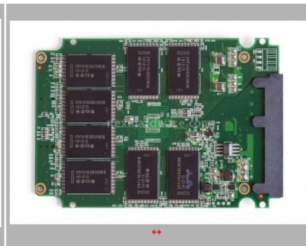
Il controller utilizzato è il classico SandForce SF-1222TA3-SBH, praticamente lo stesso visto sia sul Patriot Inferno che sul Vertex 2 precedentemente testati.
