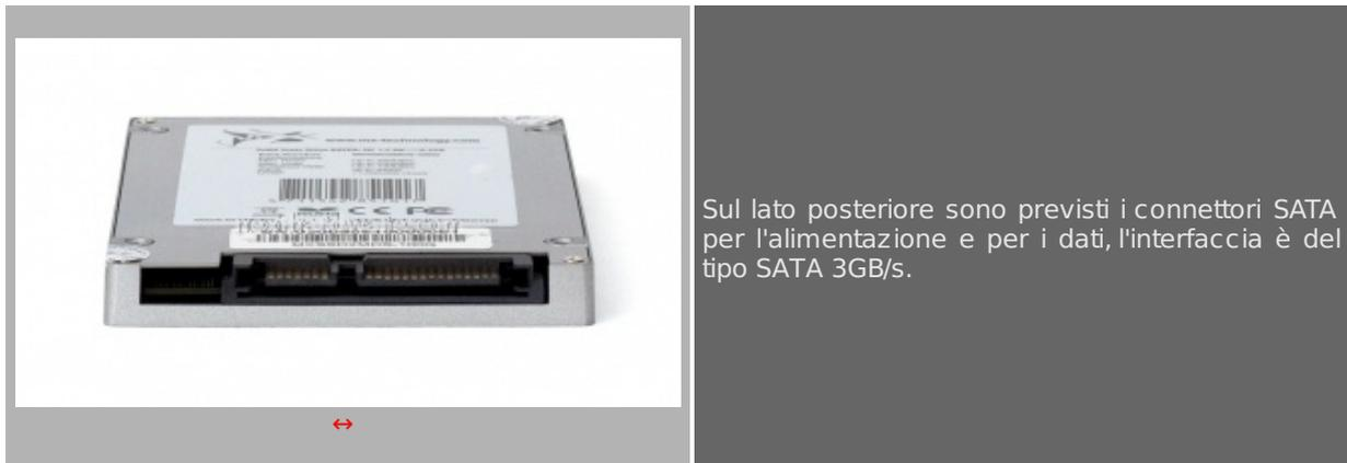
Sul lato posteriore sono previsti i connettori SATA per l'alimentazione e per i dati, l'interfaccia è del tipo SATA 3GB/s.
