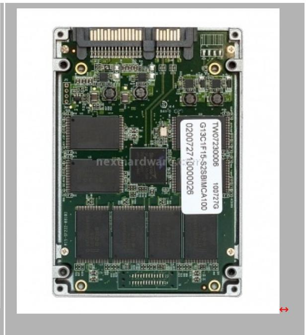
Tolti i due sigilli di garanzia, abbiamo rimosso le 4 viti che assicurano il fondo dell'SSD alla struttura e, una volta rimosso, abbiamo accesso al PCB del disco. Quest'ultimo è a sua volta avvitato alla parte superiore dell'SSD tramite altre 4 viti.
