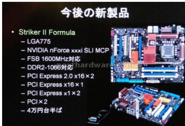
Sono apparse le prime immagini della futura scheda madre di casa ASUS con chipset Nvidia 780i. Le principali features sono, il supporto alle nuove CPU intel 45nm e alle DDR2 1066, sei porte S-ATA, tre slot PCI-E e due connettori Gigabit Ethernet.
