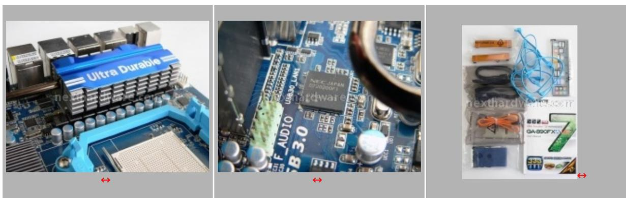
Il bundle della UD7 è composto da 2 bridge CrossFire di lunghezza superiore a quelli standard, che permettono lâ€™™ installazione delle schede negli slot più appropriati distanziando le schede in configurazioni a 2 o 3 GPU, 4 cavi SATA, una serie di prolungher ESATA/SATA ed un cavo IDE.
