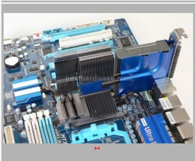
A differenza dei normali dissipatori per schede madri, tutta la struttura è ancorata con viti dotate di molle che garantiscono una migliore tenuta ed un perfetto bilanciamento di tutte le parti del sistema di raffreddamento. A nostro avviso, tutta questa struttura è eccessiva: basta ricordare infatti, che il chipset AMD 890FX ha un TDP massimo di 19.6 W e che la maggior parte del calore è comunque generato dalla sezione di alimentazione.
