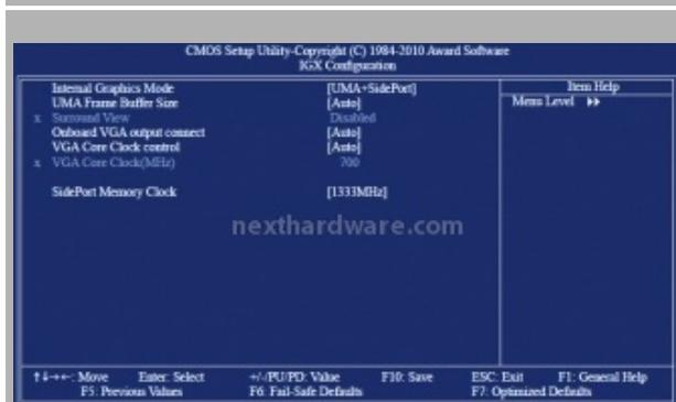
Dal menù IGX Configuration è possibile variare la modalità di funzionamento della memoria condivisa / Side Port e le frequenze operative del core della GPU e della Side Port stessa.
