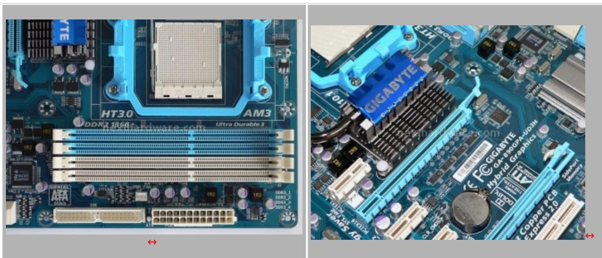
Gli slot di memoria DDR3 presenti sulla GA-890GXA-UD3H sono quattro e possono essere configurati per operare, in condizioni di overclock, a frequenze superiori ai 1866Mhz. Nelle nostre prove abbiamo utilizzato un kit di Corsair Dominator GT 1600 Mhz CAS 7 7 7 21 1T impostando manualmente le principali latenze e tensioni all'interno del BIOS senza riscontrare alcun problema di stabilità. Per attivare la
