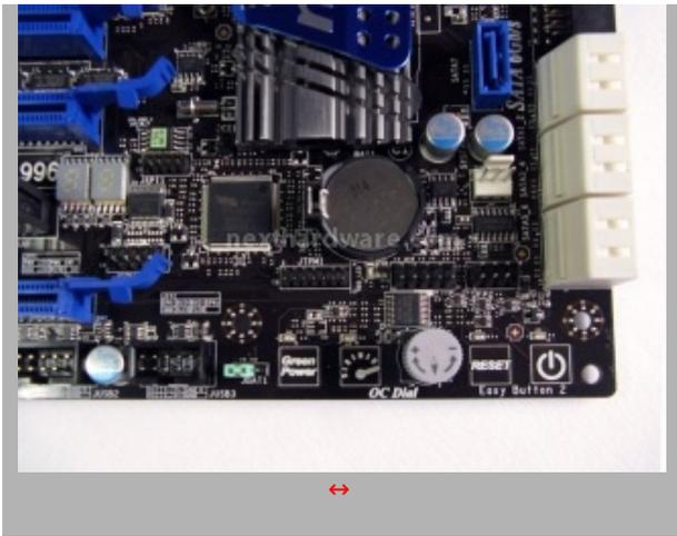
Appena sotto l'ultimo slot PCIe è presente un interruttore di forma circolare che, se attivato, permette l'overclock automatico della mainboard.
