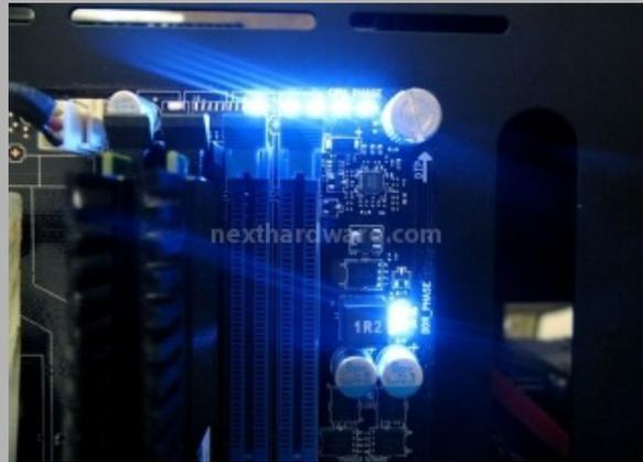
Panoramica che mette in evidenza gli slot dimm Dual channel per DDR3.
