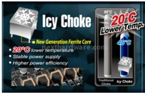
I nuovi core in ferrite, che compongono ogni singolo stadio di ciascuna delle fasi, sono del tipo SFC (Super Ferrite Choke). La ferrite super permeabile, di cui sono composti, garantisce il 30 % in più di erogazione di corrente con 35°C in meno sulle temperature raggiunte; una temperatura operativa più bassa e una maggiore erogazione di corrente assicurano overclock più stabili con frequenze più elevate.
