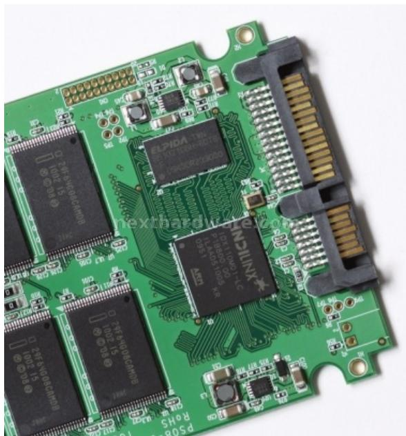
Una foto che ci mostra da vicino i componenti principali dell'SSD: il controller Indilinx Barefoot, il chip della cache che è un Elpida S51321DBH-6DTS-F (SDRAM DDR da 64MB a 166MHz Cl3), i chip NAND Flash. Questi ultimi sono degli IMFT 29F64G08CAMDB prodotti a 34nm dalla joint venture tra Intel e Micron, conformi alle specifiche ONFI 2.1 e, al momento, rappresentano il top in termini di prestazioni ed affidabilità .
