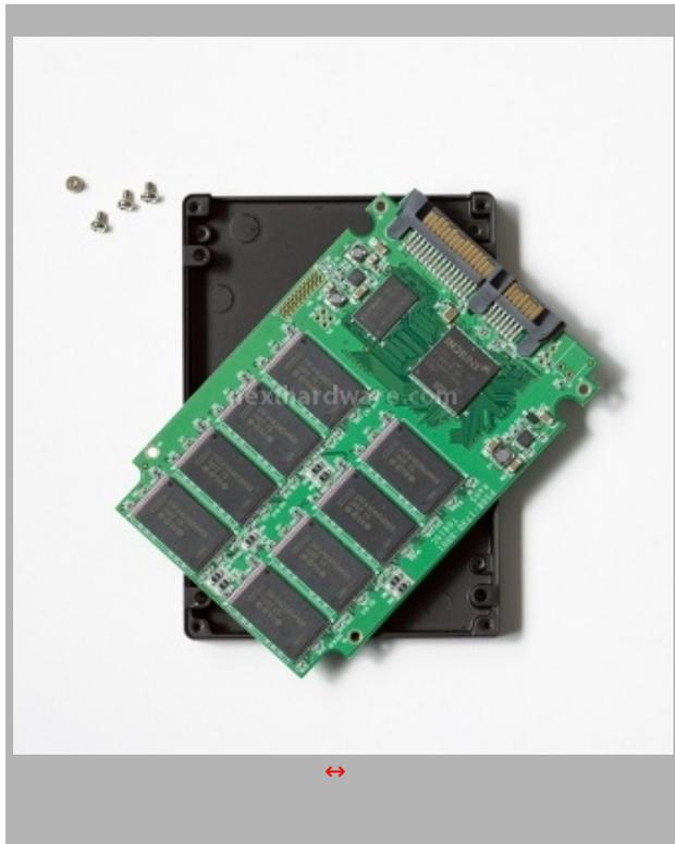
Il Corsair V128 Nova Series prevede una classica struttura assemblata a sandwich bloccata da 8 viti. Quattro viti bloccano la paratia protettiva in alluminio, le successive 4, assicurano il pcb al telaio.
