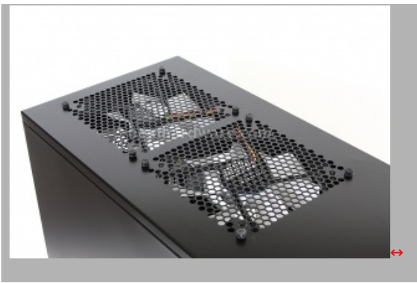
Le due ventole da 140mm del top, viste dall'esterno. Si notino le teste dei gommini di fissaggio anti vibrazioni.
