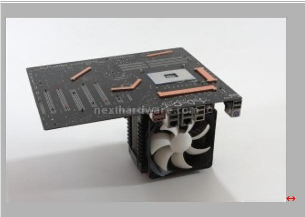
Una volta fissate le staffe, è necessario disporre sui quattro perni filettati, le guarnizioni in dotazione. A questo punto, abbiamo scelto di ribaltare il dissipatore e di provvedere al fissaggio definitivo appoggiando la scheda madre su di esso.
