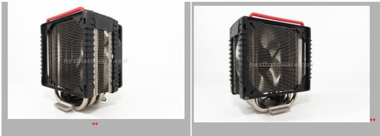
Il corpo radiante si presenta solido e compatto, le dimensioni sono abbastanza contenute, 48 le alette di raffreddamento collegate alle 5 heat pipes da 8mm. Gradevole la struttura in plastica atta ad accogliere le ventole di raffreddamento.
