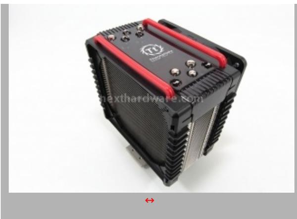
La parte superiore del cooler ci mostra un carter molto ben realizzato che, a nostro avviso, non ha soltanto una funzione estetica, ma contribuisce ad evitare fughe del flusso d'aria che rimane così convogliato in senso esclusivamente orizzontale, ottimizzando quindi il lavoro delle ventole. Questa tipologia di funzione sembra essere assoluta anche dai supporti delle ventole.
