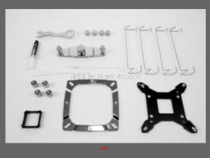
Il bundle di Venomous comprende un manuale di istruzioni per il montaggio, un adesivo Thermalright per poter personalizzare il proprio case e la serie degli accessori per l'assemblaggio. Anche per Venomous, come per Arrow, la compatibilità è ristretta alle piattaforme di casa Intel. La polivalenza delle piastre di montaggio ha permesso di ridurre a due, una superiore ed un backplate posteriore, gli accessori necessari per l'accoppiamento del dissipatore alla scheda madre.
