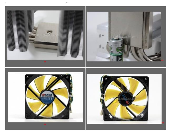
La base, superiormente, presenta un alloggiamento dedicato al sistema di fissaggio del dissipatore alla scheda madre. In quanto a lappatura della base stessa, non ravvisiamo una superficie lucida, segno che, evidentemente, l'attenzione maggiore è stata dedicata alla planarità della stessa. Visti i risultati ottenuti da "True Spiritâ€, abbiamo ragione di credere che la lucidatura a specchio della base sia una caratteristica del tutto marginale.
