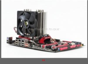
Operazione di montaggio completata in maniera semplice e, sopratutto, veloce. Anche se Noctua, per i sistemi di montaggio, ha fatto e fa ancora scuola, possiamo affermare con certezza che anche Thermalright si può aggiungere alla lista dei "docentiâ€. Il sistema sviluppato per Venomous X è notevole per semplicità e versatilità con il suo backplate multi compatibile.
