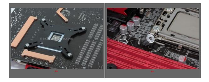
Una volta serrato il backplate, posizioniamo al di sopra dei perni filettati, la struttura di ancoraggio del dissipatore.
