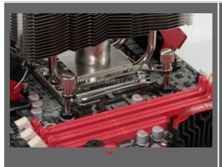
Non resta quindi che accoppiare alla base del dissipatore le opportune staffe ed inserire i dadi di serraggio. Gli stessi, per impedire che fuoriescano dai fori preposti durante le fasi di montaggio, devono essere dotati di un o-ring di blocco.
