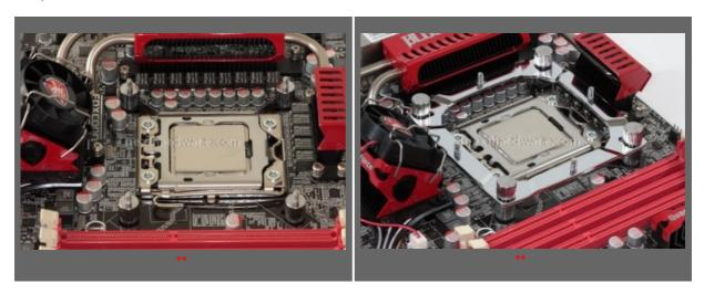
Possiamo quindi passare al montaggio vero e proprio del corpo radiante. Nelle immagini vediamo le due viti con molla che provvedono all'ancoraggio. Il pomello centrale, caratteristica del tutto innovativa, provvede ad aumentare la pressione di serraggio fino ad un massimo di 70 lbs. E' possibile regolarlo per mezzo di una specifica "chiave†in dotazione.
