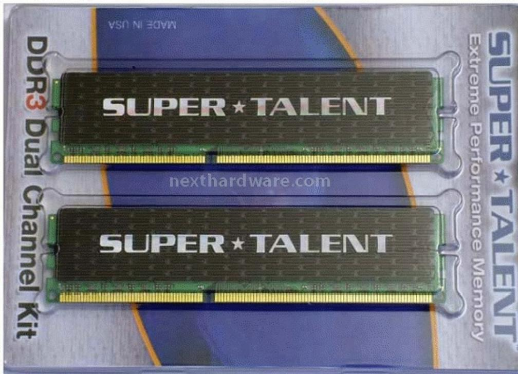
I dissipatori sono realizzati in alluminio ad alta efficienza per consentire uno smaltimento del calore ottimale e al tatto confermano l'™ impressione di robustezza e solidità che si era avuta visivamente. C'è da dire che il dissipatore di alluminio è presente solo in un lato delle memorie e a seguire nella recensione scopriremo il perché di questo fatto.
