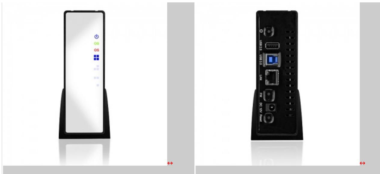
IB-NAS5310 NAS è equipaggiato con chip Oxford Oxe 810SE da 367MHz, capace di consentire lo streaming video e il supporto DLNA a televisioni di ultima generazione e console casalinghe come Xbox 360 e PlayStation3.
