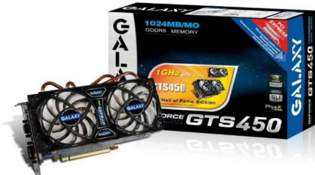
Galaxy annuncia la nuova GeForce GTS 450, dotata di 1GB di memoria grafica, un'™ interfaccia di memoria a 128bit, un dissipatore dotato di due ventole da 92mm ed un corpo dissipante costituito da quattro heatpipes in rame, per giocare gli ultimi titoli dei videogiochi alla massima risoluzione senza problemi.
