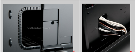
Sopra, illustrata dalla foto, la gualina che protegge e rifinisce il passaggio dei cavi provenienti dall'alimentatore. Tutta la cassetteria alimentazione/dati è alloggiata in un vano nascosto e ricavato alla base del Level 10 (foto a dx).
