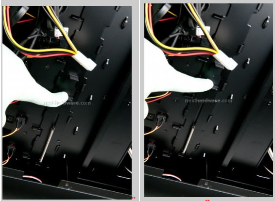
La piastra verticale di metallo che, scorrendo, blocca/sblocca l'accesso ai vani HDD e unità aggiuntive.
