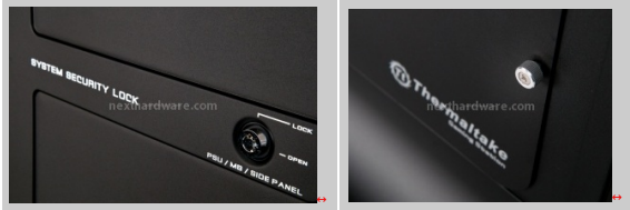
Il sistema di sicurezza dei vani frontali System Security Lock del Level 10. Nella fotografia a destra, una gradita sorpresa: la paratia è assicurata da due viti impermeabili dotate di testa zigrinata, allentabili facilmente anche senza disporre di un cacciavite.
