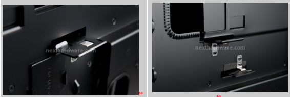
In evidenza il sistema utilizzato per bloccare uno dei vani anteriori. Particolare sulle finiture interne, foto a dx.
